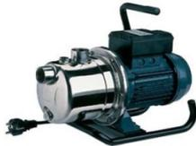
Horizontale, einstufige Kreiselpumpe, selbstansaugend, mit 1,5m Kabel und Schukostecker, max Saughöhe: 8m Betriebsdruck: 6bar; Spannung 230V/50Hz
